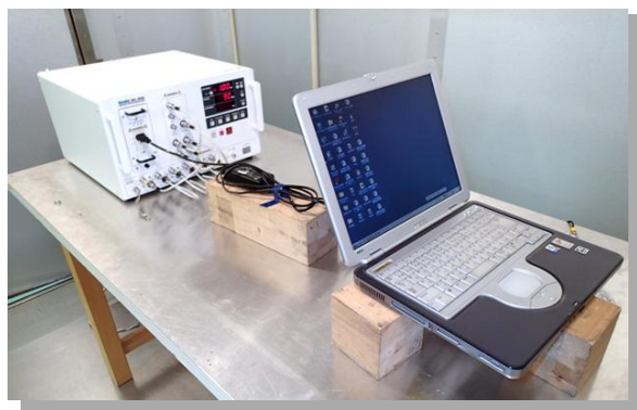
図2 コンピュータの電源線へのノイズ印加試験
