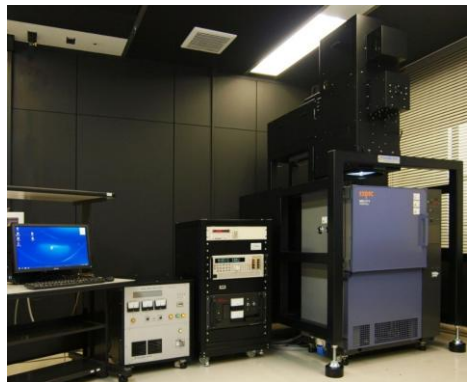
恒温槽付き2灯式ソーラーシミュレータ 山下電装製 YSS-T150A
